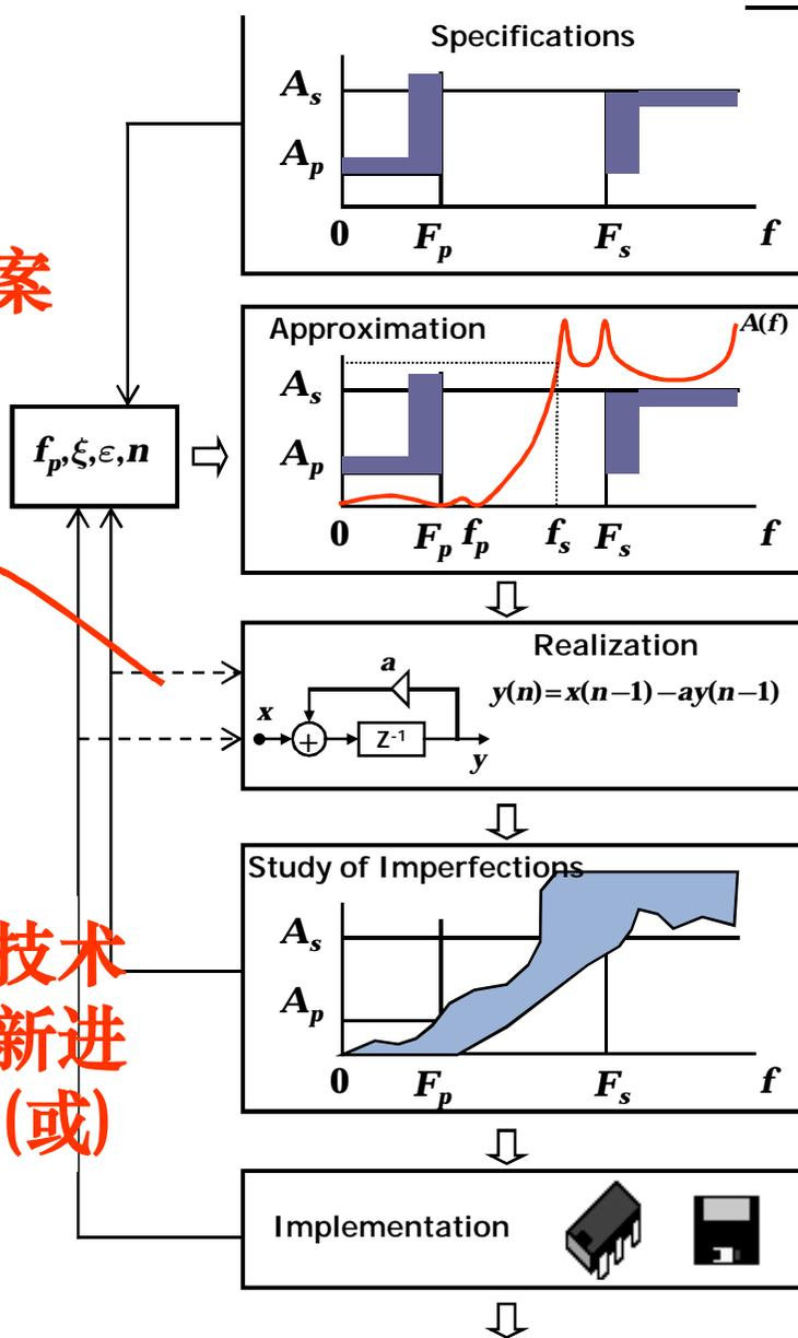
**技术指标:** 按设计任务, 确定滤波器性能要求, 制定技术指标;
