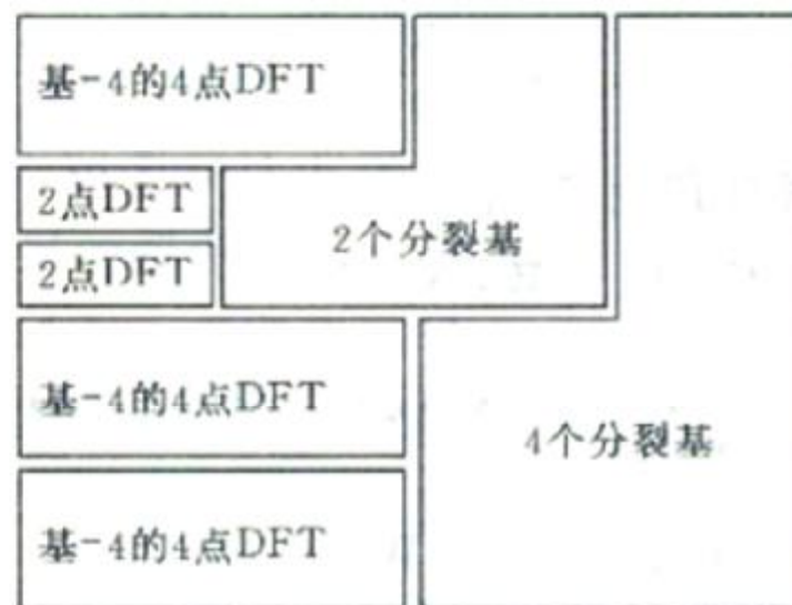
图 4-25 N=2^4=16 点的分裂基 FFT 的示意图
