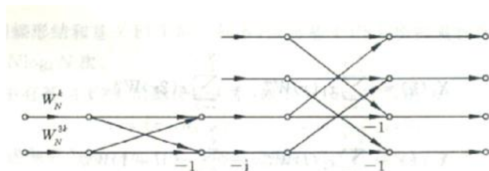
图 4-24 分裂基 FFT 算法的一个基本蝶形运算
